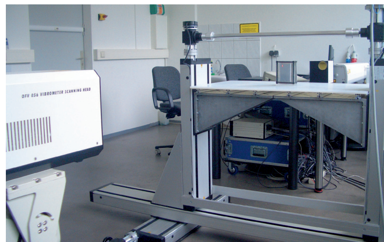
Bild 2: Versuchsanordnung Bildmitte: Positioniersystem mit Probe; rechts hinten: Anregungslaser mit Scanner; links: Scanning-Laservibrometer
