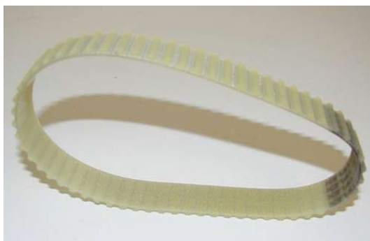
Bild 1: Querbewegtes Objekt mit 3D-Oberflächenstruktur. Beispiel hier: Zahnriemen
