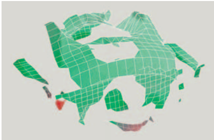
Bild 3: Betriebsschwingform eines Bremssattels gemessen mit dem Scanning Vibrometer
