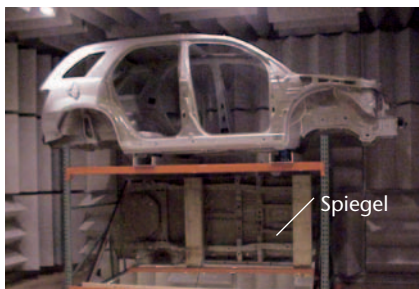
Bild 1: Messaufbau der SUV-Karosserie
