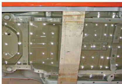
Bild 2: Messpunkte am Unterboden
