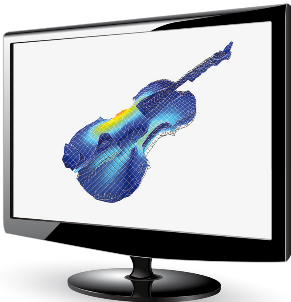
Klangoptimierung durch vollflächige Schwingungsmessung.
