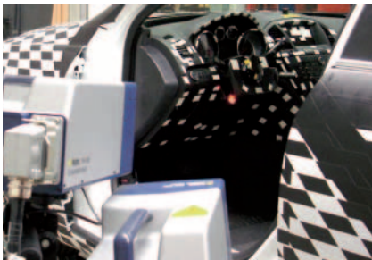
Messung der Strukturdynamik im Innenraum
