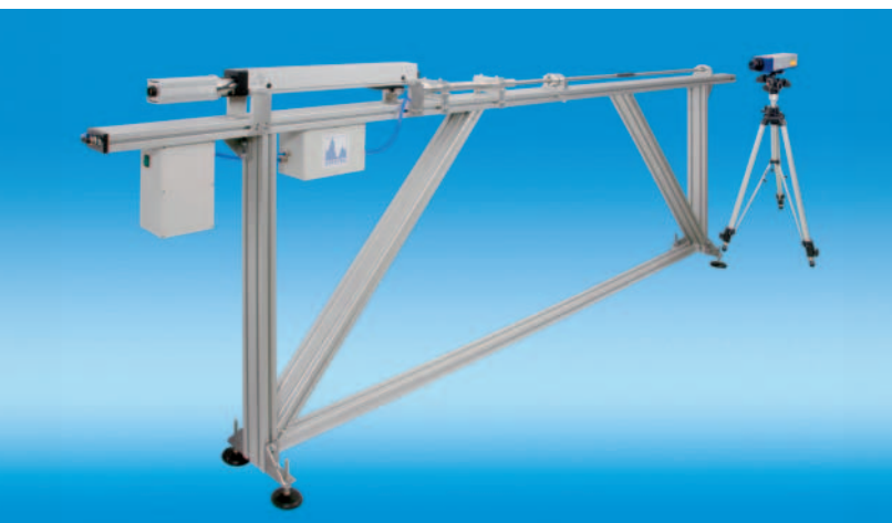
Bild 1: Messanordnung mit Hopkinson-Stab
