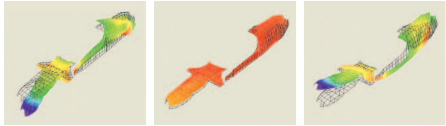
Bild 4: Phasen der Karosserieschwingung bei 120 Hz
