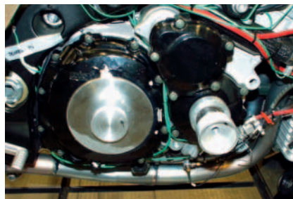
Bild 4: Messpunkte an der Kurbelwelle und Getriebewelle
