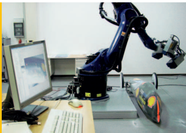
Bild 2: Schwingungsmessungen am Schluckspecht mit der RoboVib Structural Test Station
