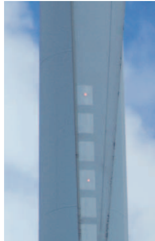
Bild 2: Laserpunkte auf den Reflexfolien am Rotorblatt
