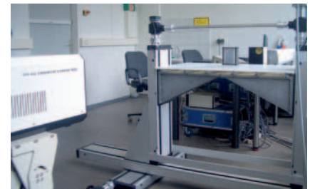
Bild 2: Versuchsanordnung Bildmitte: Positioniersystem mit Probe; rechts hinten: Anregungslaser mit Scanner; links: Scanning-Laservibrometer
