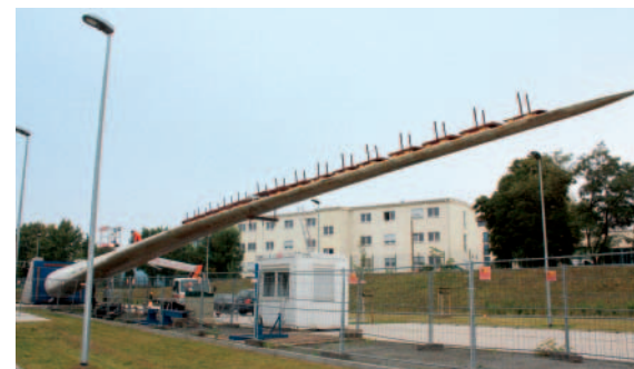
Bild 1: komplettes Rotorblatt mit zusätzlichen Massenpaketen am Versuchsstand auf dem IMA-Gelände Dresden
