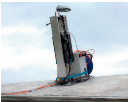
Bild 2: Anregung durch einen elektromotorischen Shaker von Firma Wölfel
