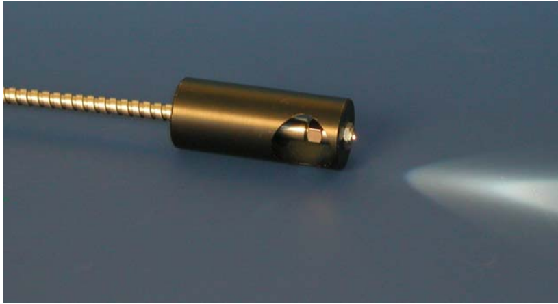
Bild 2: Typische Sonde für berührungsfreies Monitoring mit NIR-Spektroskopie
