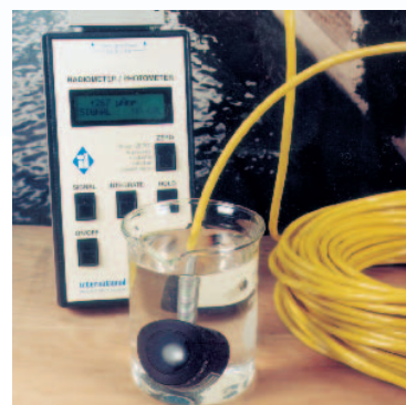
Unterwassermessungen in bis zu 40 m Tiefe
