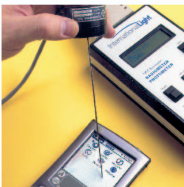
Helligkeitsmessungen mit Miniatur-Faseroptik, z. B. an LCD-Displays
