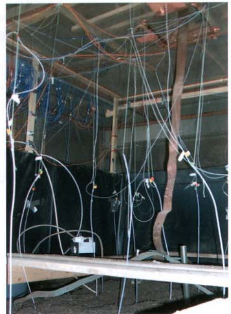
Bild 5. Versuchsanlage des Umweltforschungszentrums UFZ Leipzig-Halle zur Bodensanierung
