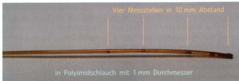
Bild 4. Vierfachsonde zur ortsauflösenden Messung
