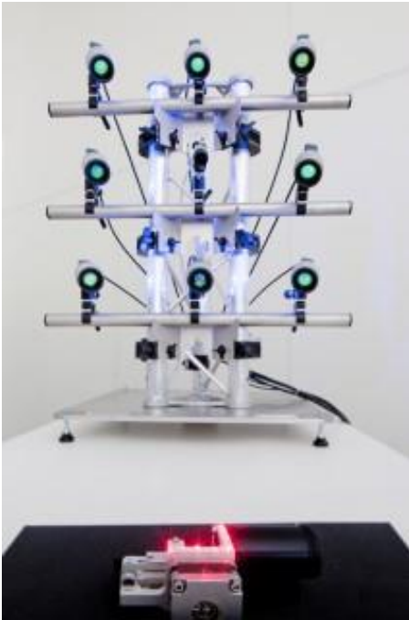
Abb.1 MPV-800 Multipoint Vibrometer erfassen transiente Schwingungsphänomene wie Hochläufe an Elektromotoren
