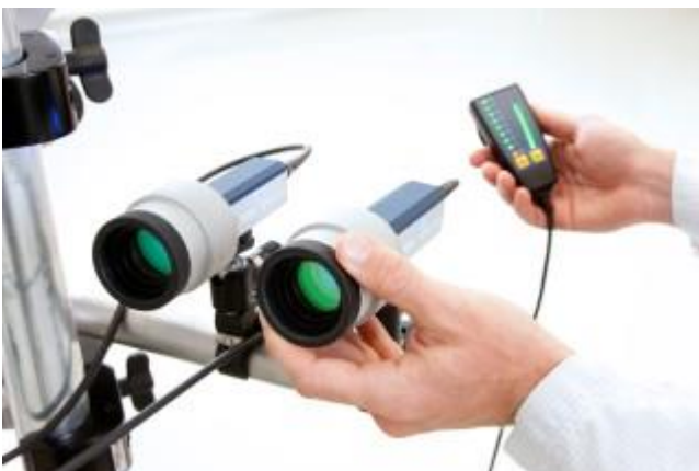
Abb. 2: Justage mit Signalpegelanzeige für die faseroptischen Messköpfe
