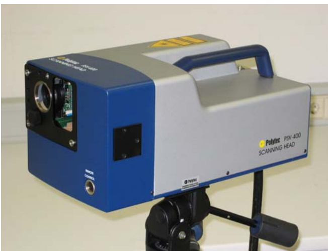
Abbildung 2: Polytec Scanning Vibrometer PSV-400, Messkopf
