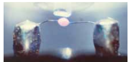
Die faseroptische Temperaturmessung in der „berührungslosen“ Konfiguration am Beispiel eines Zünddrahtes
