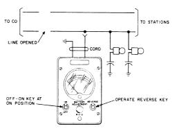
BALLISTIC TEST FOR GROUNDED RINGERS
